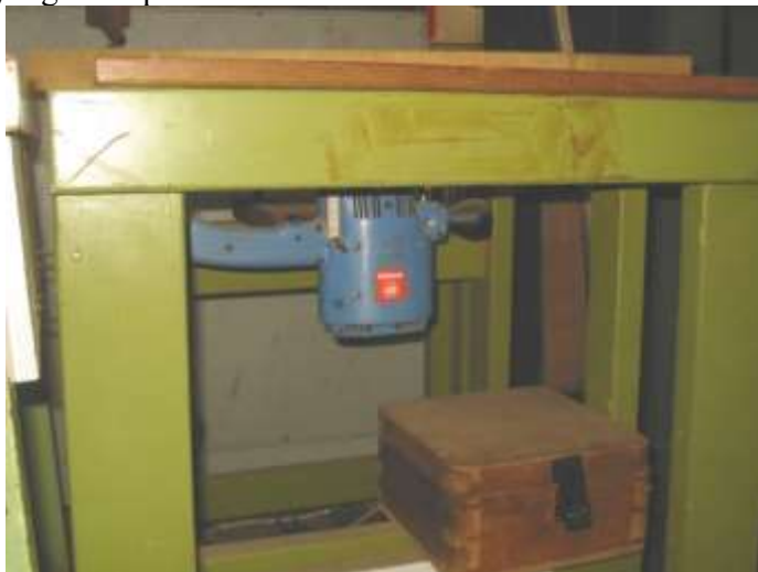
Gambar: Contoh pengembangan mesin router tangan dengan daun meja tambahan.
