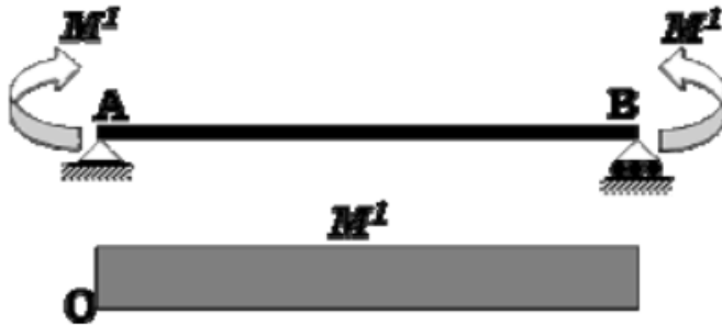
Gambar 2.2 Lentur murni balok sederhana (Mulyati, 2023)
